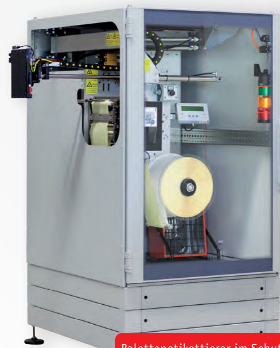
Palettenetikettierer im Schutzschrank mit eingebauter Heizung
