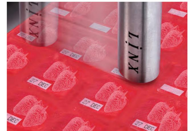
Perfekt zur Integration in eine **Verfahrenheit bei mehrbahniger Anwendung**. Nur ein Drucksystem ist zur schnellen und exakten Beschriftung erforderlich.
