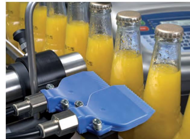
Bei Einsatz **im nassen Produktionsumfeld** trocknen **separate Luftdüsen die Beschriftungsfläche** und garantieren dadurch eine gleichbleibend hohe Druckqualität.
