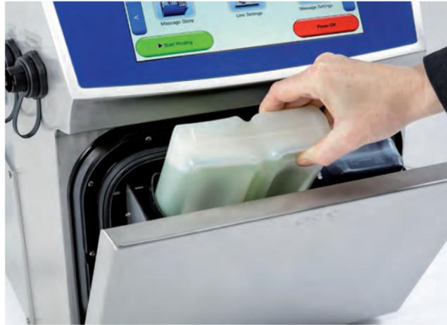
Sauberes, schnelles und verwechslungssicheres **Nachfüllen** von Tinte und Solvent **ohne Produktionsunterbrechung**.
