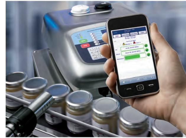
**Linx Insight® Web Interface** für Textdownload und -kontrolle ermöglicht dem Bediener die Remote-Anzeige **via PC oder Smartphone**.
