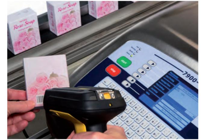
Mit **QuickSwitch®** lassen sich ganz einfach Daten durch Scannen des Barcodes auf zu codierenden Produkten oder vorgedruckten Auftragszetteln für einen Druckwechsel eingeben.
