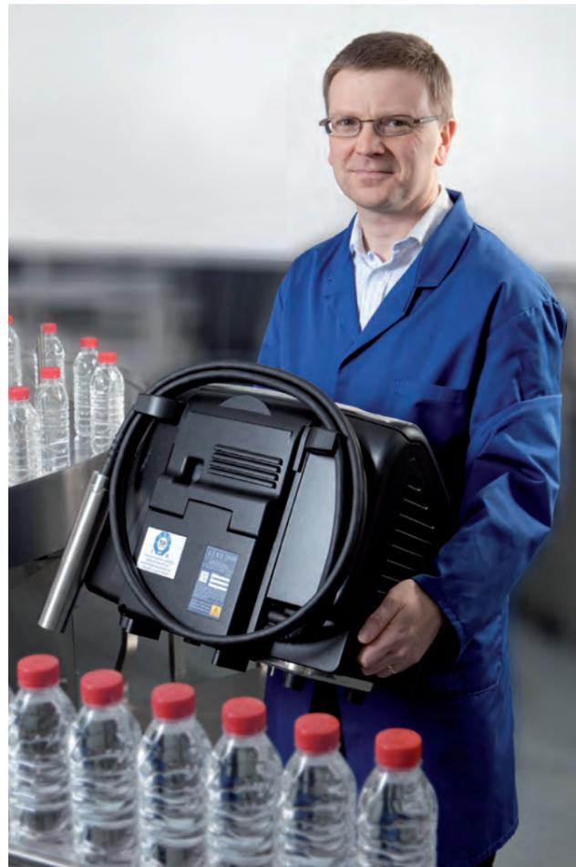
**Kompakt und nur 13,5 kg leicht.** Ohne großen Aufwand kann der CJ 400 Drucker zwischen verschiedenen Produktionslinien hin- und herbewegt werden.
