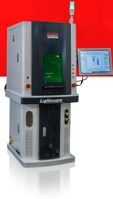
Der neue **Lightworx** ist eine Kombination aus **leistungsstarkem Faserlaser** und **professioneller Arbeitsstation** mit einem unschlagbaren Preis-Leistungs-Verhältnis. Er eignet sich daher insbesondere für den Einstieg in die industrielle **Laserkennzeichnung**. Unternehmen aus der Metall- und Kunststoffbranche können mit dem Lightworx im Handumdrehen Typenschilder, Gehäuse oder Werkzeuge kennzeichnen – dauerhaft, gestochen scharf und fälschungssicher.
