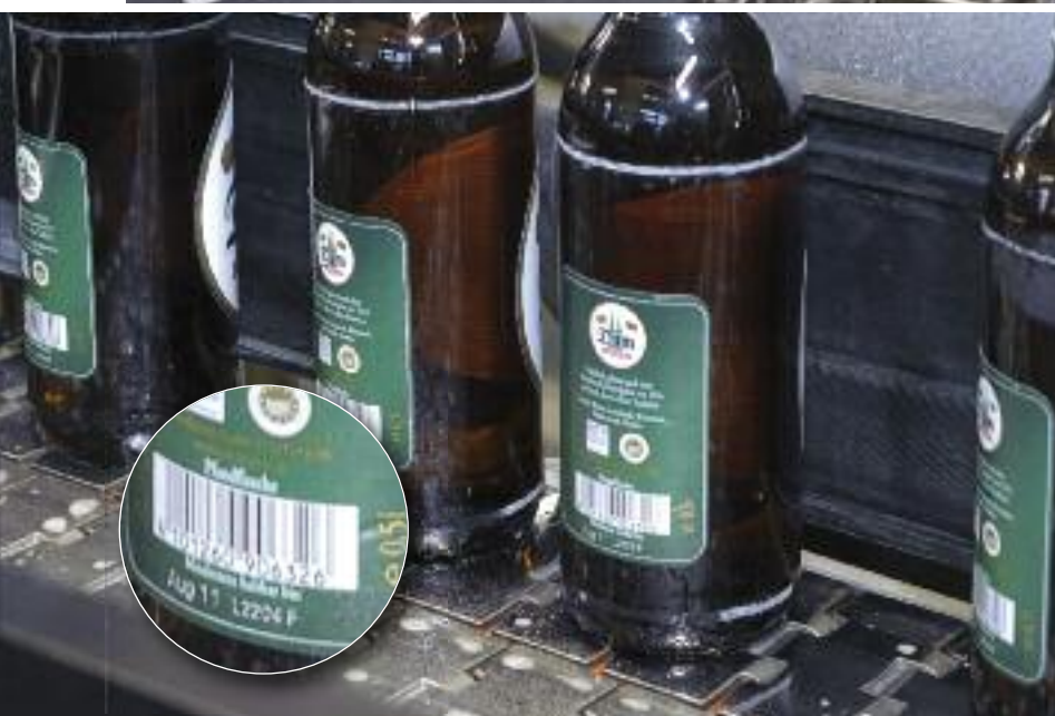
Während des Beschriftungsvorgangs trägt der Laser die grüne Farbe auf den Etiketten ab, sodass eine deutlich sichtbare weiße Kennzeichnung entsteht.
