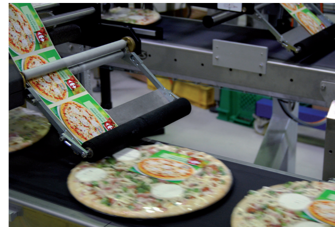
Branche: Lebensmittel Anwendung: Etikettierung von abgepackten Pizzen
