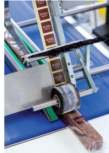
Branche: Süßwaren Anwendung: Etikettierung von Schokoladenriegeln
