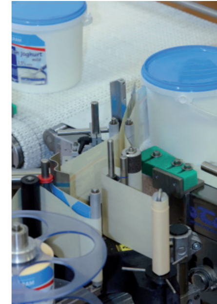
Branche: Molkerei Anwendung: Etikettierung von Eimern mit Joghurt
