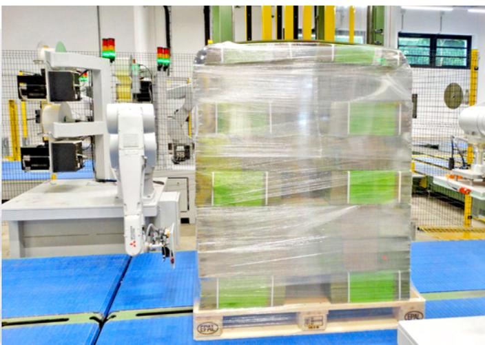
Die Roboterarme verwenden Tamp-Blow-Spendestempel, die sich an unterschiedliche Etikettenformate anpassen lassen. Da alle gängigen Druckmodule eingebunden werden können, ist z.B. mit einem Zebra 220 Xi4-Drucker die Verarbeitung von DIN A4 großen
